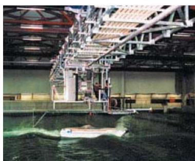
Test w zbiorniku do holowania w Marintek A/S w Norwegii.
