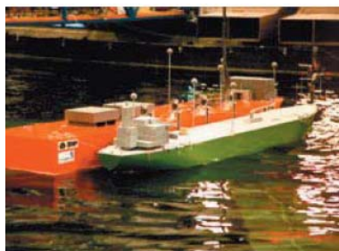
Testowanie modelu na nadbrzeżnym zbiorniku w DHI, Dania
